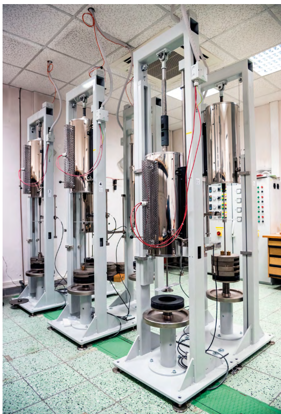
Obr. 8 Některé přístroje, např. zatěžovací stroje pro vysokoteplotní zkoušky v creepu, si vědci sami vyrábějí a nabízejí do dalších laboratoří.
